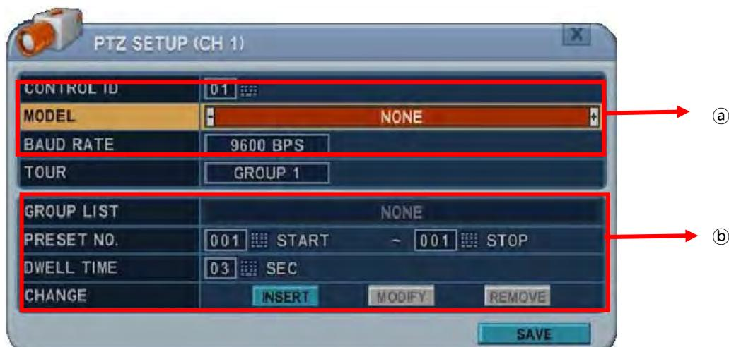
a. **Настройки подключения.** Выбрав модель (Model), указать скорость обмена данными (Baud rate), а также адрес поворотного устройства (PTZ ID).
