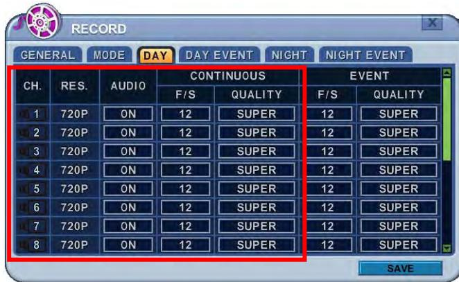
Видеорегистратор выполняет запись видеофрагментов непрерывно в течение 24 часов. Настройки записи предназначены для записи в нормальном режиме. Для каждой камеры можно указать собственные настройки. Чтобы скопировать настройки на другой канал, нужно нажать клавишу [Display].
