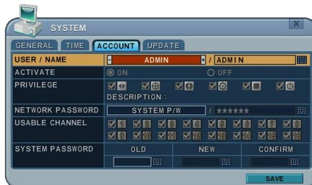
3) **Network (Сетевая конфигурация).** В настройках по умолчанию видеорегистратора указан системный пароль на доступ к сети для администратора и/или запрет на сетевой доступ для обычных пользователей. Для изменения сетевого пароля следует вызвать функцию "Custom P/W" (Пользовательские настройки пароля).
