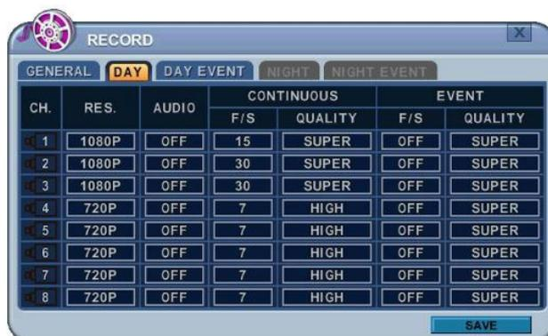
При нажатии клавиши "REC" начнётся запись в **нормальном** режиме (Normal) при скорости 6 к/с (30F/S), с высоким качеством (High). После возникновения события на этом канале качество изображения повысится до очень высокого (Super) при той же скорости 30 к/с. После окончания установленного времени записи события будет выполнено переключение в **нормальный** режим записи.
