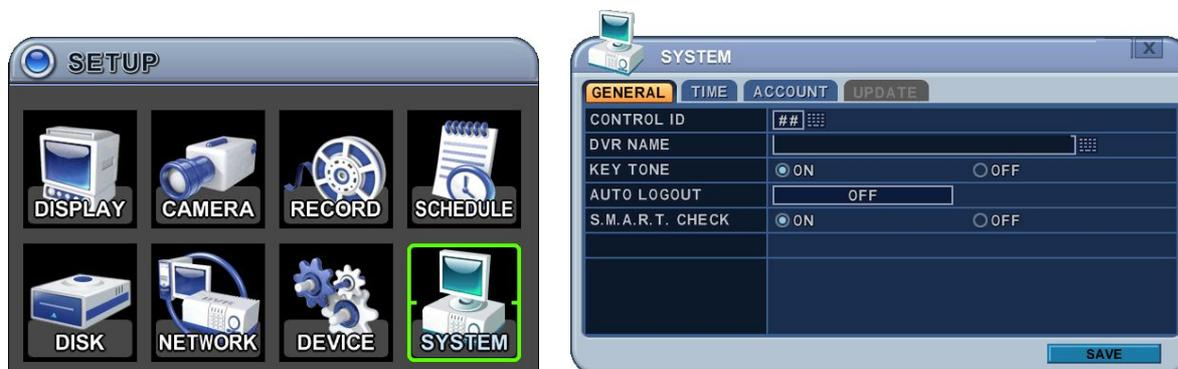
1. **Control ID** (Идентификационный номер видеорегистратора)—каждым предварительно настроенным видеорегистратором можно управлять с помощью пульта ДУ.
