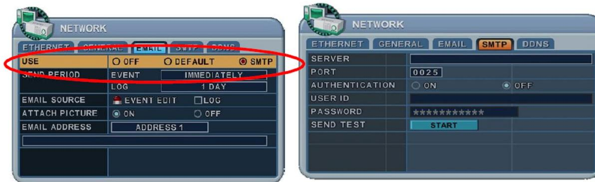
1. **Server** (Сервер). Указать имя или IP-адрес почтового сервера. Для ввода имени сервера можно воспользоваться виртуальной клавиатурой, а также цифровыми клавишами на пульте ДУ или на передней панели устройства.
