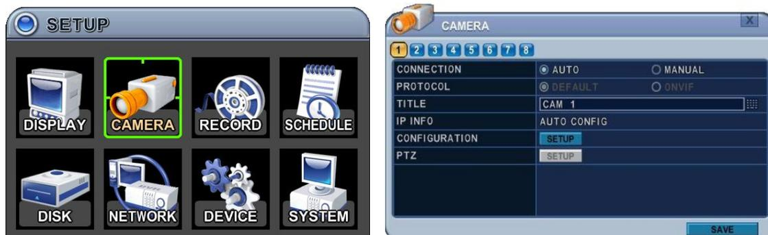
Выберите номер камеры, используя для перемещения курсора клавиши [◀▶], или укажите номер камеры цифровой клавишей. Канал активен, если к нему подключена IP-камера. Номер камеры будет выделен другим фоном, а на экране появятся текущие настройки этой камеры.
