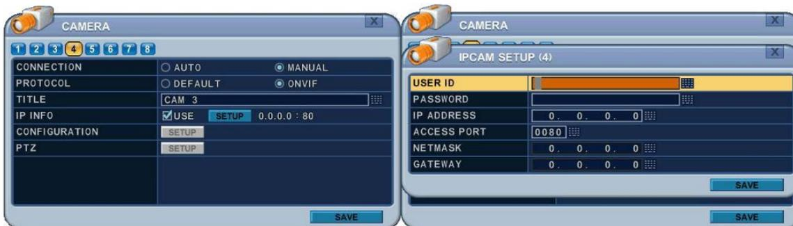
Нажмите кнопку УСТАНОВКА (SETUP) в пункте конфигурации CONFIGURATION, чтобы увидеть подробную информацию или настроить функцию камеры.
