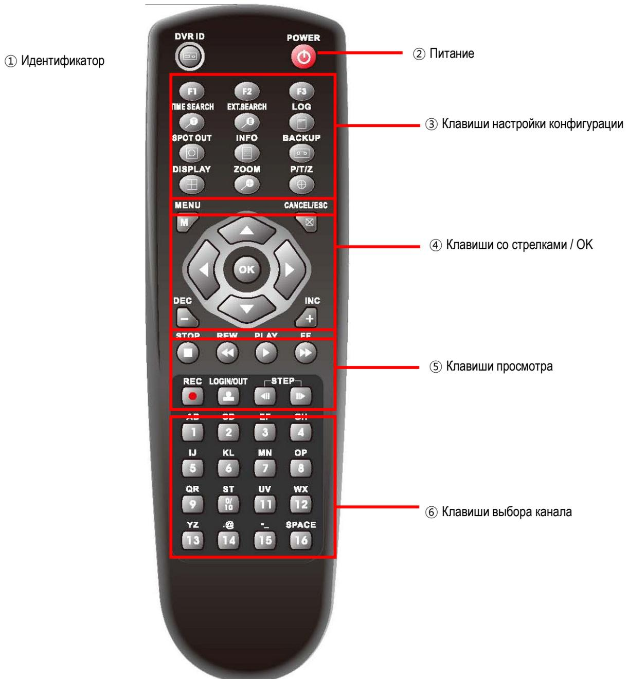
**NVR ID (Идентификационный номер видеорегистратора):** Для выбора идентификационного номера видеорегистратора следует нажать клавишу "ID" на пульте ДУ, и удерживая её, нажать на две секунды цифровую клавишу с желаемым номером. В случае установки ID равным "0" пользователь получает право управлять несколькими видеорегистраторами одновременно.
