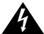
Данный символ используется для предупреждения пользователя о наличии внутри корпуса устройства "опасно высокого напряжения", которое может вызвать поражение электрическим током.
