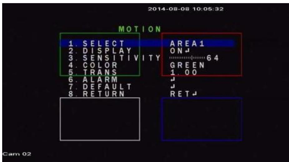
Доступна установка четырёх независимых зон детекции движения, настройка их расположения, размера и чувствительности детектора. Диапазон чувствительности детектора движения: 0-100.
