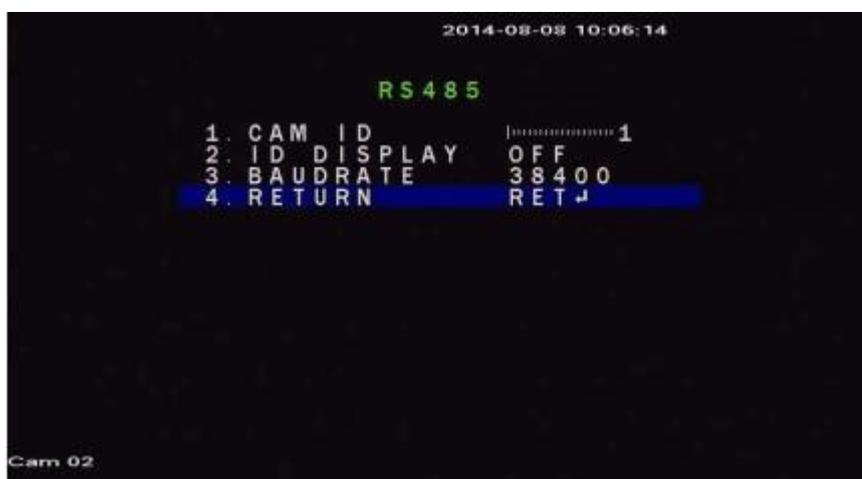
Здесь настраиваются параметры интерфейса связи RS-485: ID-номер камеры и скорость передачи данных (битрейт). Поддерживаются только два протокола передачи данных Pelco- D и Pelco-P.
