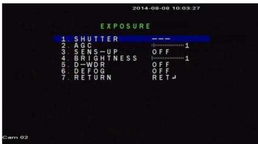
1) **SHUTTER**: Кнопками "Left" или "Right" . Вы можете вручную настроить скорость работы затвора или установить его режим работы: AUTO, 1/25, 1/30, 1/60, 1/50, FLK, 1/120, 1/250, 1/500, 1/1000, 1/2000, 1/5000, 1/10000, 1/50000, x2, x4, x6, x8, x10, x15, x20, x25, x30.
