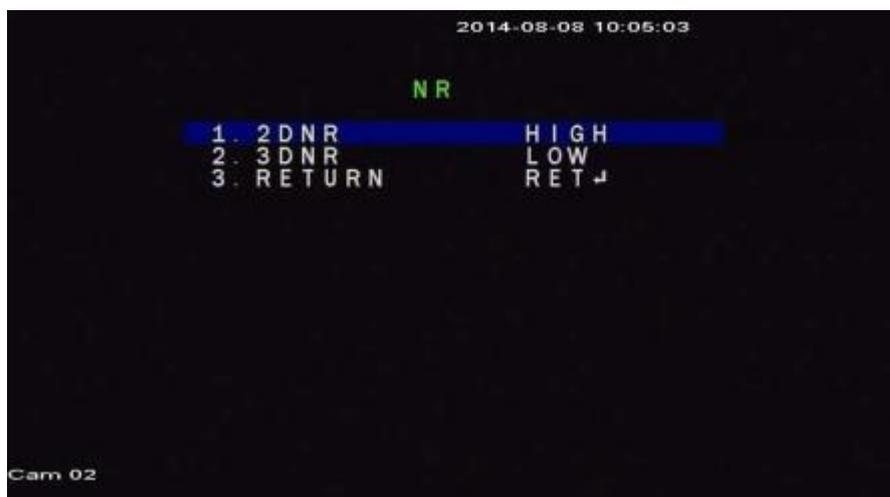
**Функция шумоподавления 2DNR и 3DNR** предназначены для устранения видео шумов в плохих условиях освещения.
