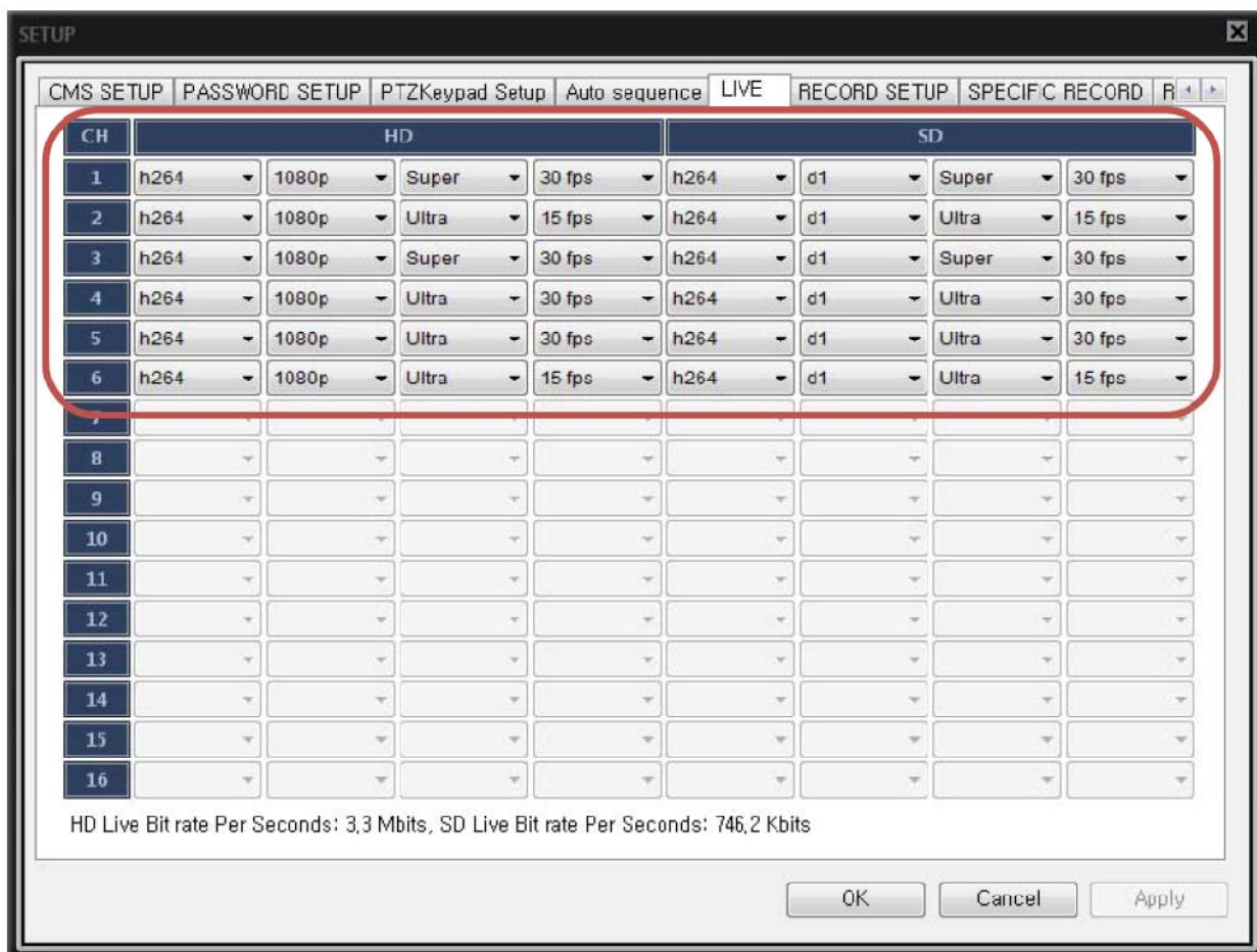
Запись ведётся по каждому каналу отдельно с последующим мультиплексированием.
