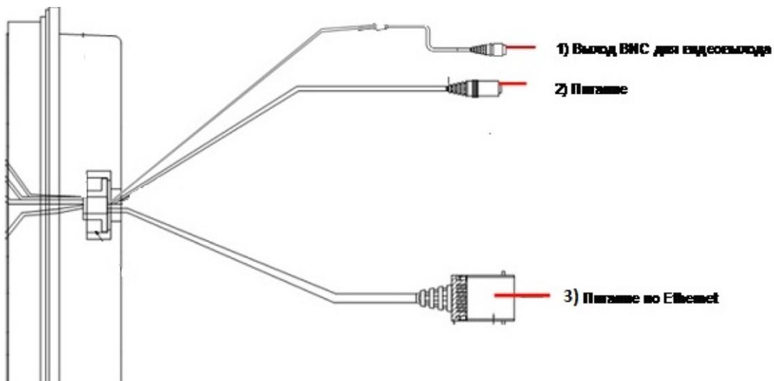
1. Композитный видеосигнал BNC.
