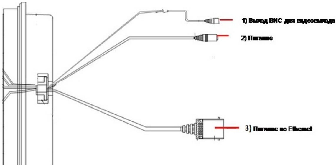
1. BNC-выход для видеомонитора. Композитный видеосигнал BNC.
