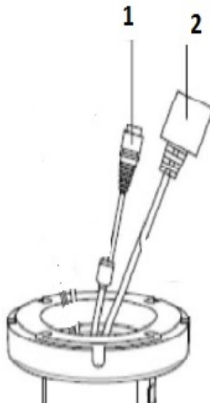
1. Питание 12 В пост. Служит для подключения сетевого кабеля к сети питания 12 В постоянного тока.
