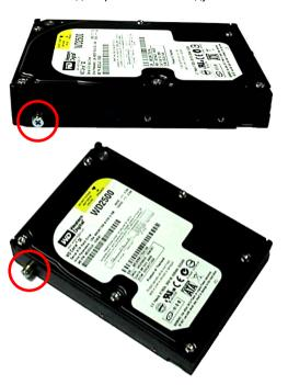
HDD имеет 6 отверстий для крепления. Установите коннектор SATA диска со стороны тела пользователя. Установите винт в левое крепежное отверстие жесткого диска.
